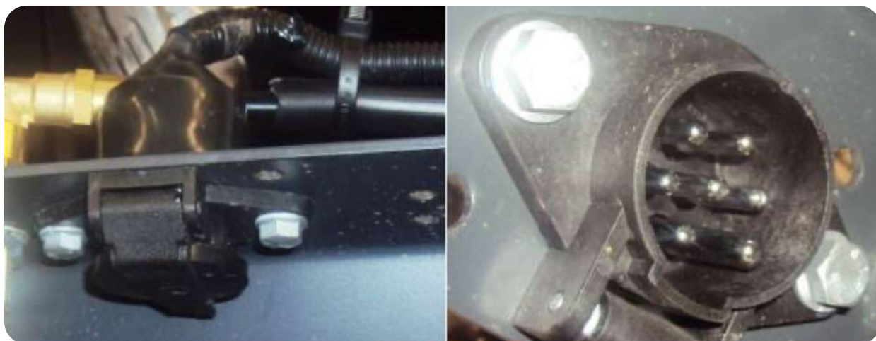
Tomada de iluminação para o implemento
